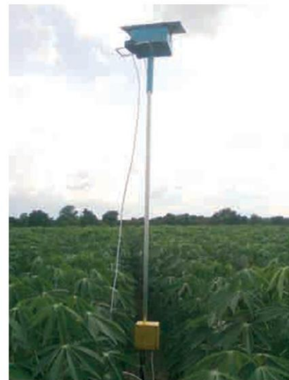
เทคโนโลยีเซนเซอร์วัดค่าความชื้นของดินทำงานร่วมกับสมาร์ทโฟน
